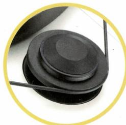
La vitesse se change manuellement en déplaçant la courroie d'une section de poulie à une autre
